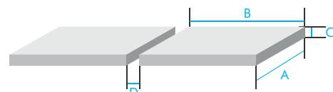
A=širina pločice (mm), B=širina pločice (mm), C=debljina pločice (mm), D=širina fuge (mm), F=gustina (kg/dm<sup>3</sup>)
